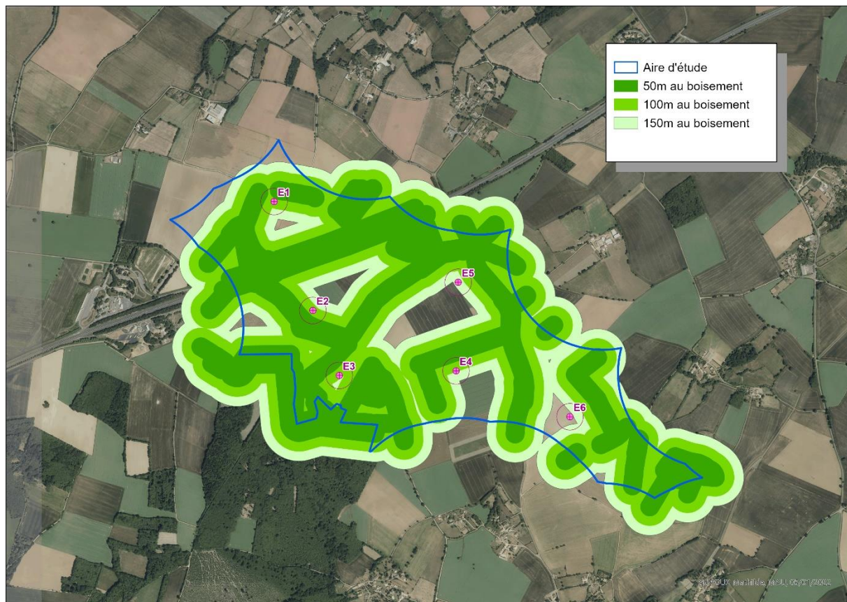
Figure 3: Implantation de la variante B, vis à vis des distances aux lisières
