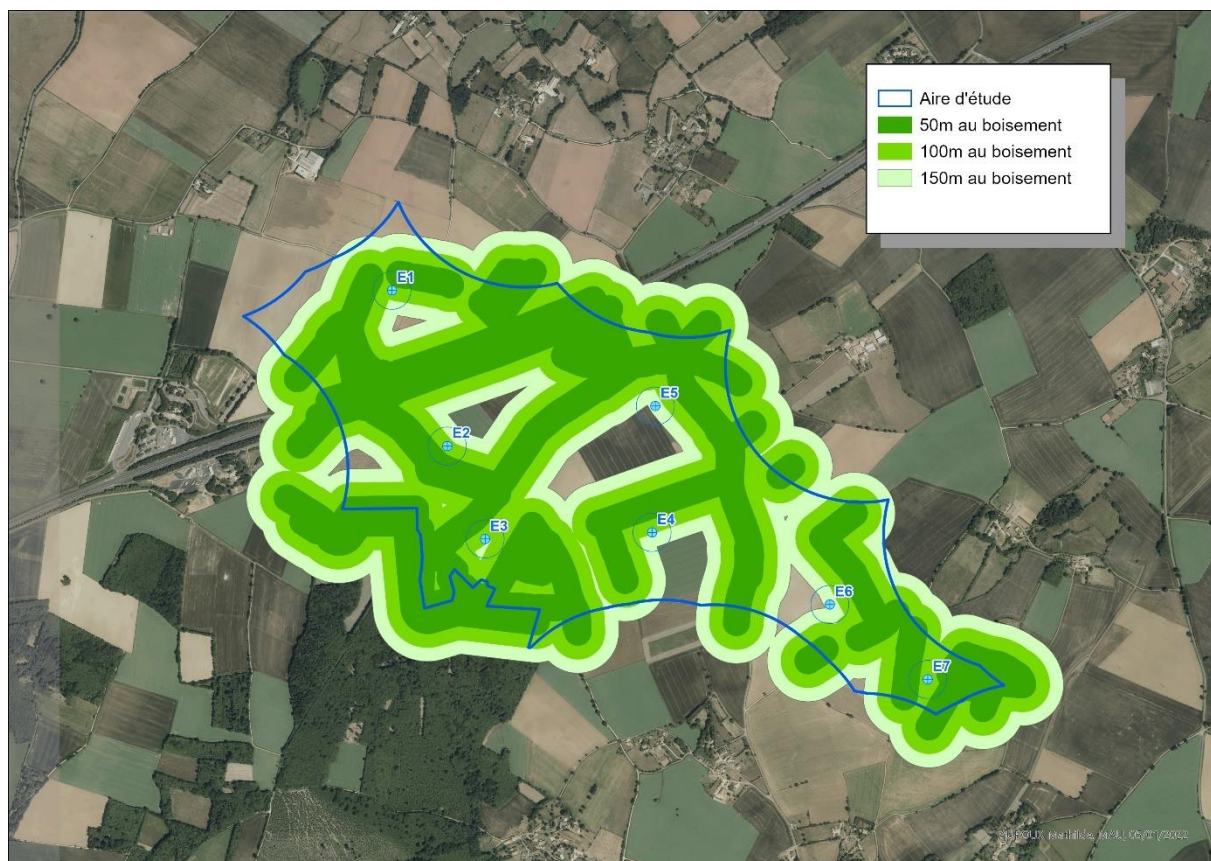
Figure 2: Implantation de la variante A, vis à vis des distances aux lisières
